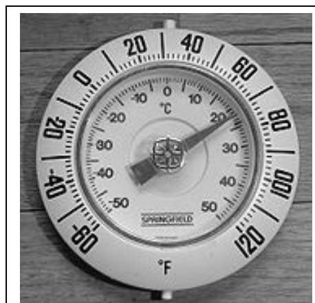
Termómetro con escala principal en grados Fahrenheit y escala secundaria en grados Celsius
